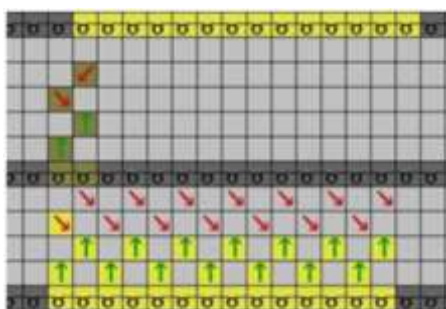
Рис.3. Фрагмент программы и графическая запись процесса закрытия отверстий после переноса петель
