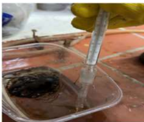
Рис. 2. Проба мазута при проведении испытаний в соленой воде
