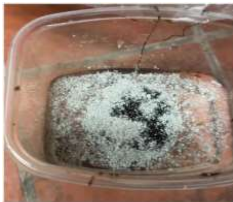
Рис. 3. Мазут в солёной воде (18 г/л) при 16 °С с нанесенным на него сорбентом
