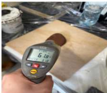
Рис. 1. Измерение температуры на твердой поверхности с помощью лазерного термометра
