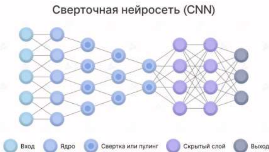
Рис. 1. Схема работы CNN
