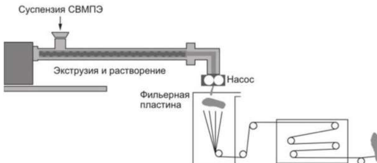
Рис. 2. Схема установки для гель-формования
