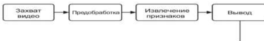
Рис. 1. Типовая архитектура системы распознавания жестов
