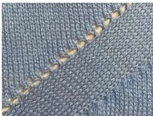
Рис.7. Трикотаж с наклонными петельными столбиками, полученными при групповом переносе на 2 иглы
