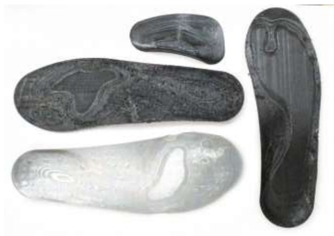
Рис.7. Образцы макетов стелек на 3D-принтере
