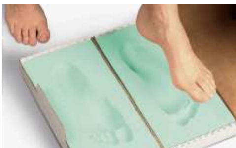
Рис. 1. Получение исходных данных методом трехмерных слепков
