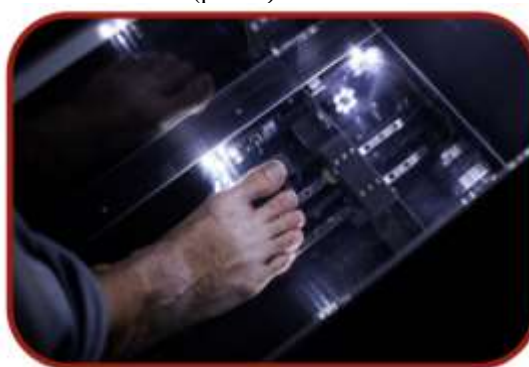
На основе полученной информации и цифровой модели можно вносить необходимые изменения и корректировки для устранения патологий. Только после этого происходит этап производства стельки, когда модель индивидуальной стельки выполняется с помощью фрезеровки или аддитивных технологий [2].
